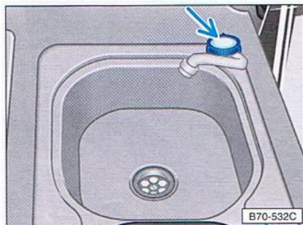
Zum Einschalten des Wasserhahnes verdrehen Sie das Oberteil (Pfeil). Eine im Frischwassertank eingebaute Wasserpumpe fördert das Wasser zum Hahn.
