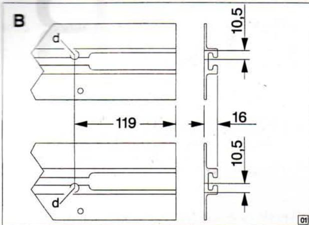
Bei einigen wenigen California Tour Fahrzeugen der Bauereihen '93 und '94 (Kennbuchstaben 'P' und 'R' auf dem Einrichtungsschild) ist der Abstand zur Rastbohrung (d) größer als für den Einsatz der zusätzlichen Sitzbank zulässig.
