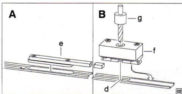
**Rastbohrung mit Bohrlehre bohren**
