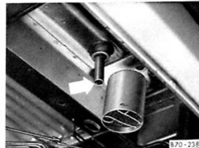
Der Abwasserstutzen (Pfeil) befindet sich links unter dem Fahrzeug, etwa 35 cm vor dem Radausschnitt des linken Hinterrades.
