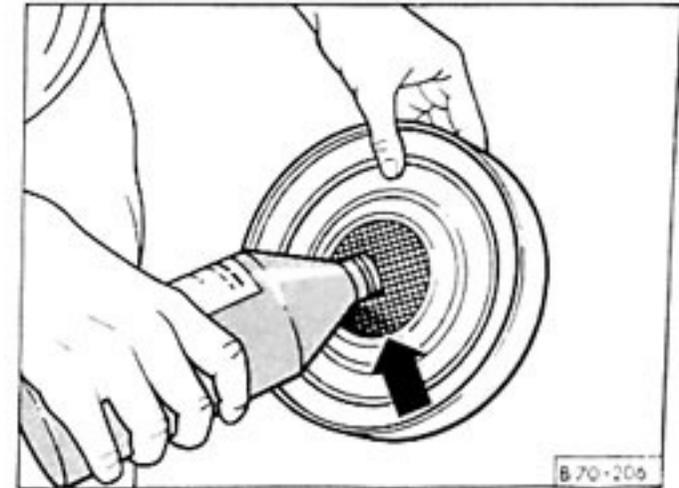
Zum Nachfüllen ist der Behälter so **schräg** nach unten zu halten, daß die Vertiefung im Brennergeflecht (Pfeil) nach unten zeigt. In diese Vertiefung Spiritus einfüllen. Der Behälter ist voll, wenn bei **senkrecht** gehaltenem Behälter Spiritus in der Vertiefung sichtbar ist.
